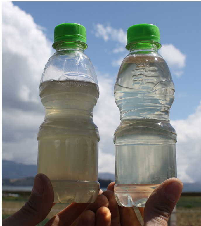
El agua antes de entrar y después de salir de los filtros verdes.
